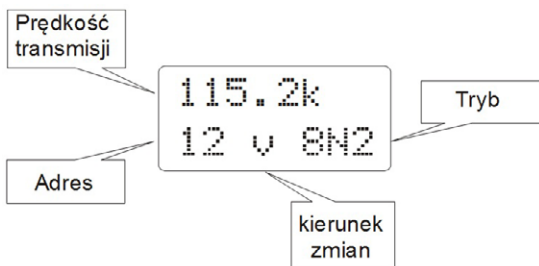
Rys. 9. Sposób wyświetlania informacji o parametrach transmisji w menu przetwornika P18D
